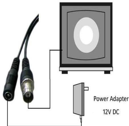
Рис. 6.1.1. Коммутация разъемов видеокамеры
